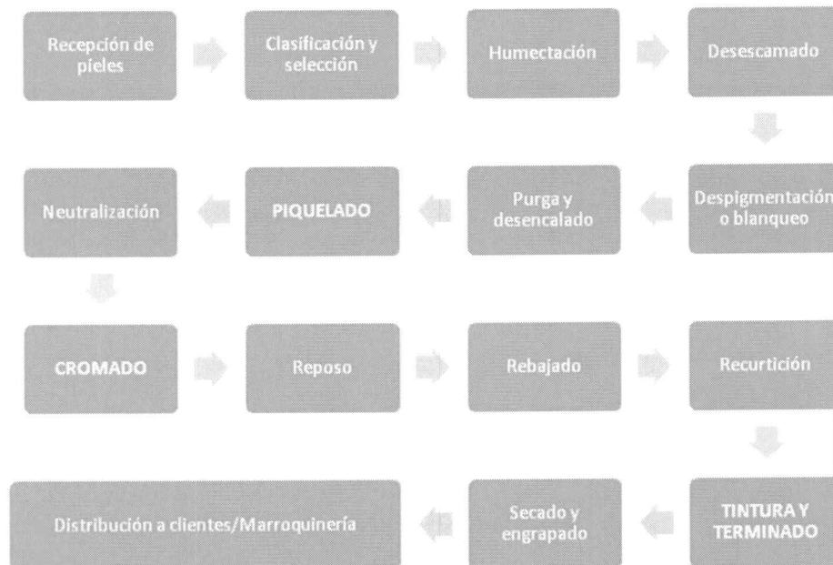
Figura 2. Diagrama de flujo del proceso de curtido y terminado de pieles.
